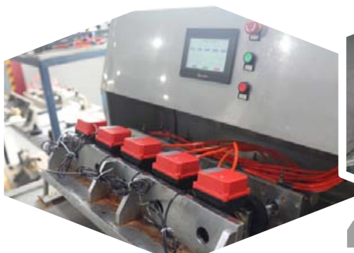
水压测试 Water pressure test
