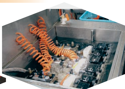
气压测试 Air pressure test
