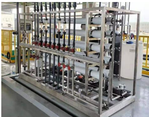
图 3-29 润景球阀应用于反渗透设备
