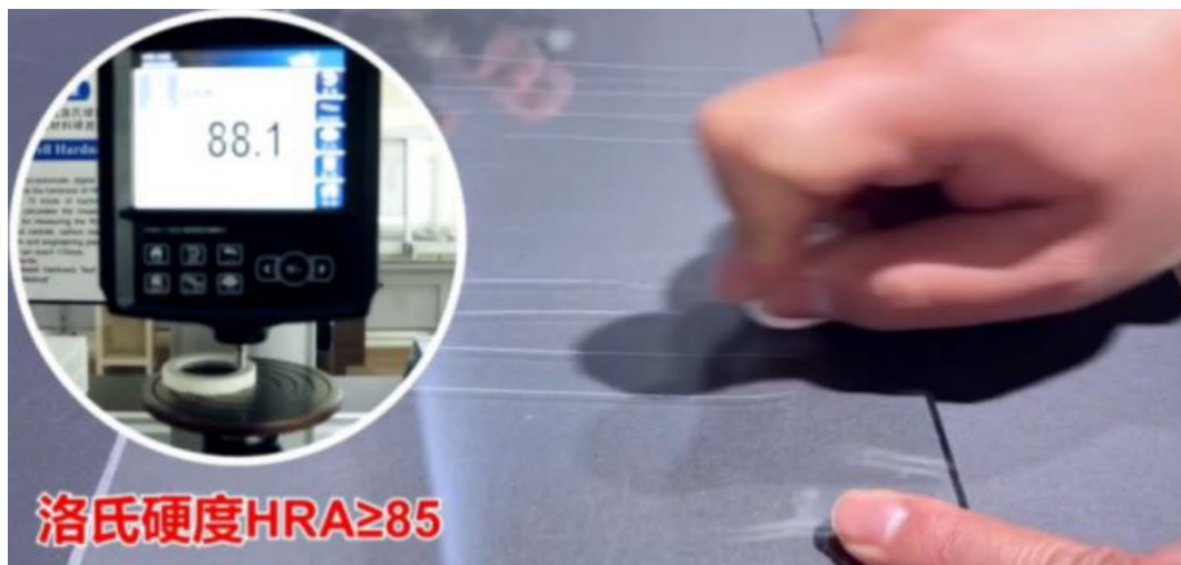
图 3-5 陶瓷硬度试验
