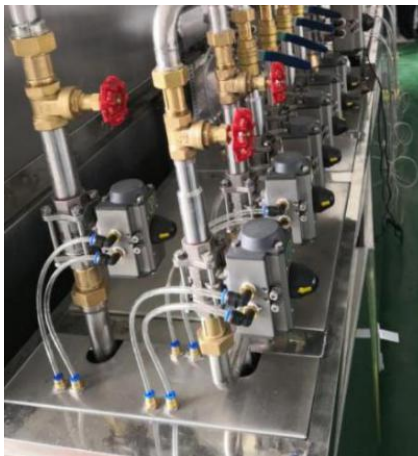
图 3-33 润景球阀应用于智能水表检定设备
