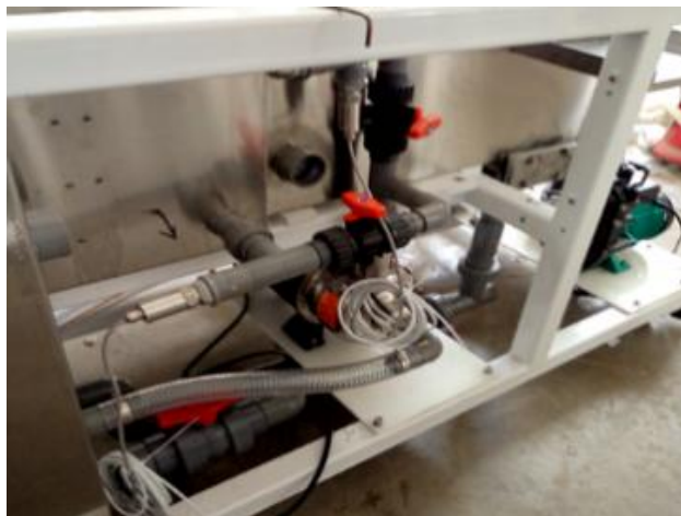
图 3-17 润景球阀应用于硅片清洗设备
