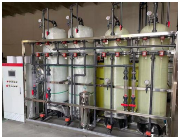
图 3-8 润景球阀应用于除氨氮设备
