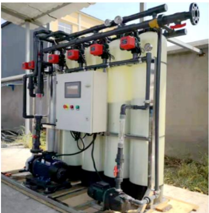
图 3-12 润景球阀应用于精密过滤设备
