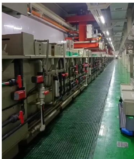
图 3-31 润景球阀应用于水箱自动补水设备
