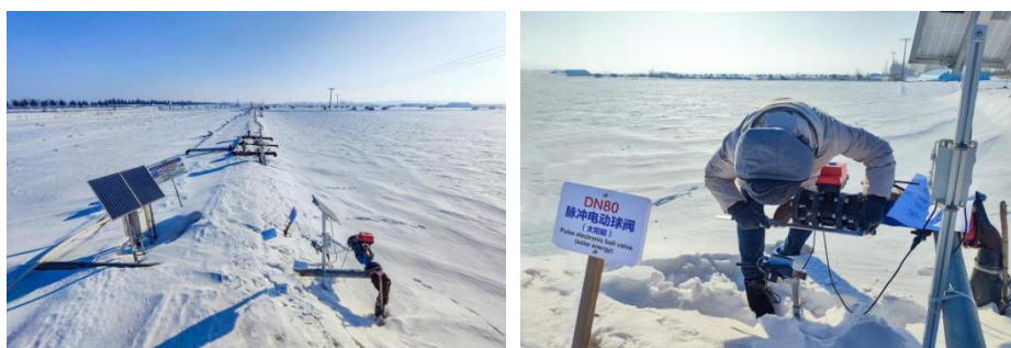
图 4-14 测试三：黑龙江绥化市庆安国家灌溉试验站(极寒地区，极端低温-40℃)
