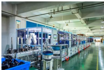
控制阀自动装配流水线
