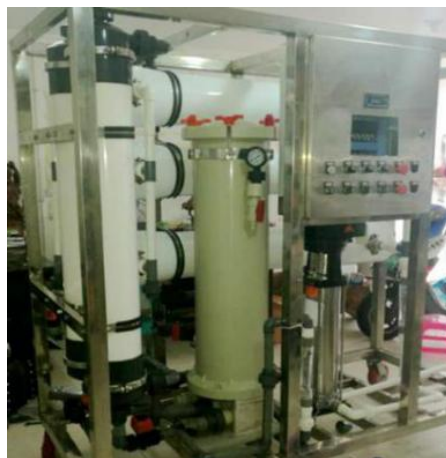
图 3-9 润景球阀应用于中水回用设备
