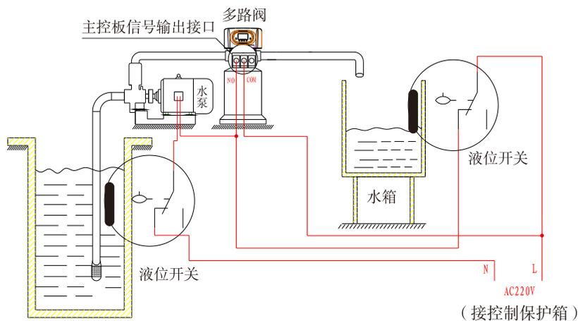
图3-5 通过水箱液位控制进水泵的接线图
