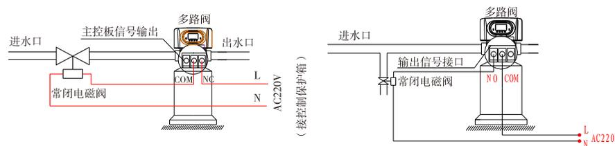
图 3-2 控制进口电磁阀的接线图
