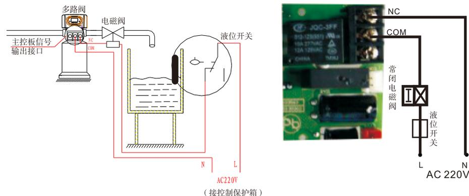
图 3-1 控制出口电磁阀的接线图
