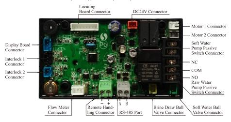
Control board of F95A3(63620), F95A1(63520), F95D3(73620), F95D1(73520), F95B3 (53620), F95B1(53520), F77A3(63618), F77A1(63518), F77B3(53618), F77B1(53518), F111A3(63620T), F111A1(63520T), F111B3(53620T), F111B1(53520T):
