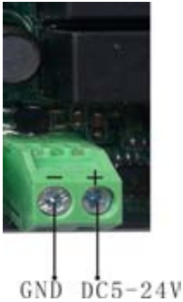
图3-9远程控制端口的接线图
