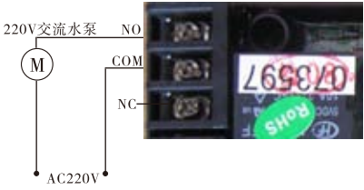
图3-6 进口接增压泵的接线图
